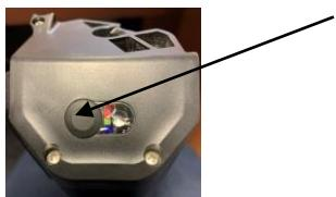
Nainstalujte baterii. Nejprve vložte baterii do drážky držáku až na doraz, otočte klíčkem proti směru hodinových ručiček a zaklapněte baterii do držáku. Klíčkem otočte nazpět a tím zůstává baterie uzamčená v držáku. Vždy když máte baterii v držáku, mějte ji uzamčenou! Pro uvolnění baterie z držáku otočte klíčkem proti směru hodinových ručiček.
