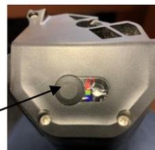
Orientačně zkontrolujte stav nabití baterie stlačením tlačítka na horní straně baterie. Pokud se rozsvítí modře dioda, baterie je plně nabitá. Zelená barva značí částečně nabitá a červená potřeba dobít.
