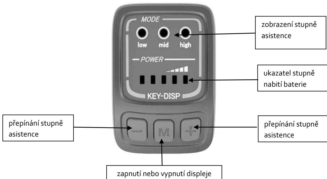
Aktivujte elektrický systém krátkým stlačením tlačítka na displeji.
