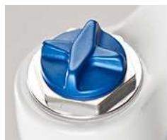
**Ventil vzduchové vidlice naleznete vlevo nahoře na korunce vidlice.** U některých modelů může být krytka ventilu spojena s dalšími ovládacími prvky (TALAS). Odšroubujte modrou krytku ventilu. Našroubujte Fox Racing Shox vysokotlakovou pumpu na automobilový ventilek. Našroukněte vidlici na požadovaný tlak, sledujte přitom manometr vidlice. Odšroubujte pumpu z vidlice, při demontáži dochází k úniku pouze z pumpy, nikoliv z vidlice. Našroubujte zpět krytku ventilu.
